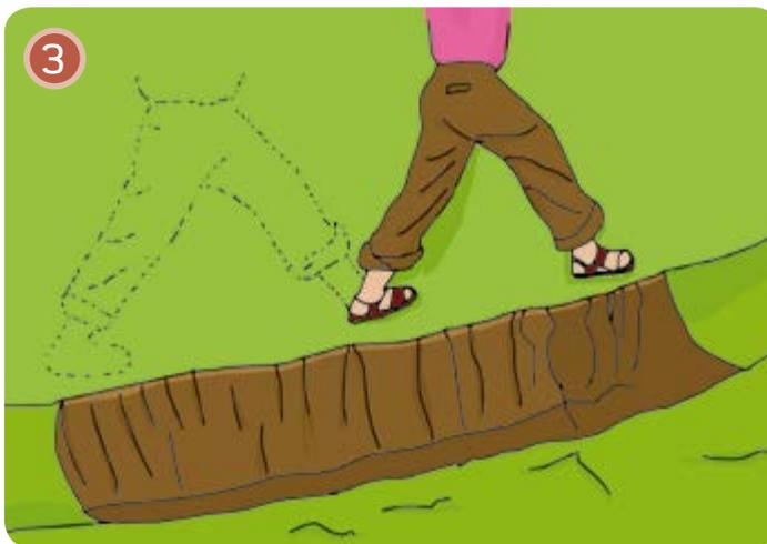
**Paso 4** Hacer la excavación, teniendo cuidado de depositar la tierra hacia arriba de la zanja, la tierra debe formar una barrera que no deje pasar el agua.
